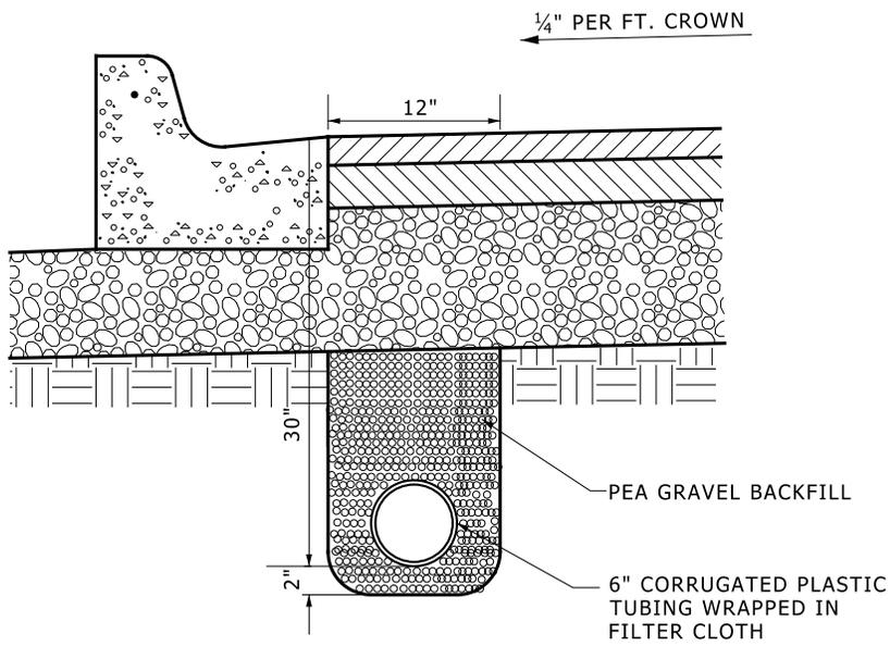
**TYPICAL UNDERDRAIN DETAIL
