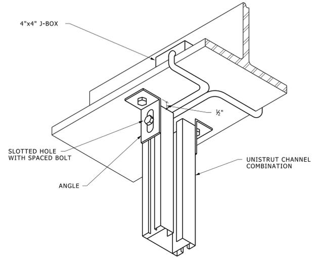
**ISOMETRIC CONNECTION AT BEAM**
