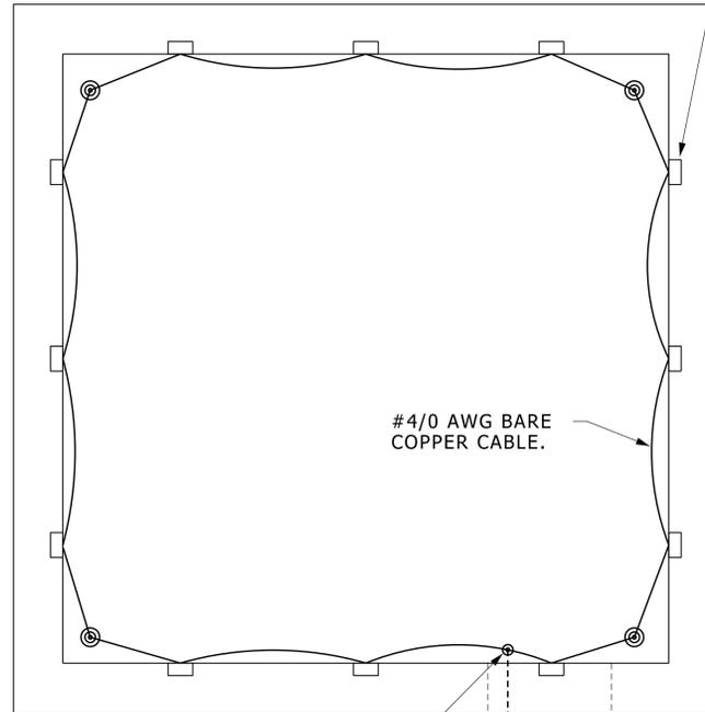
CONNECT TO GROUND CABLE FROM ALL DUCT RUNS.
