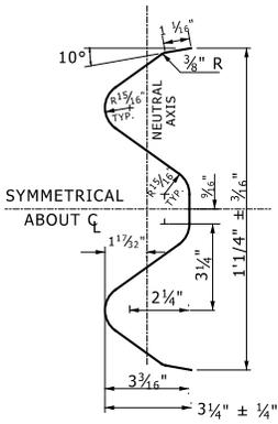
**SECTION THRU BEAM ELEMENT**
