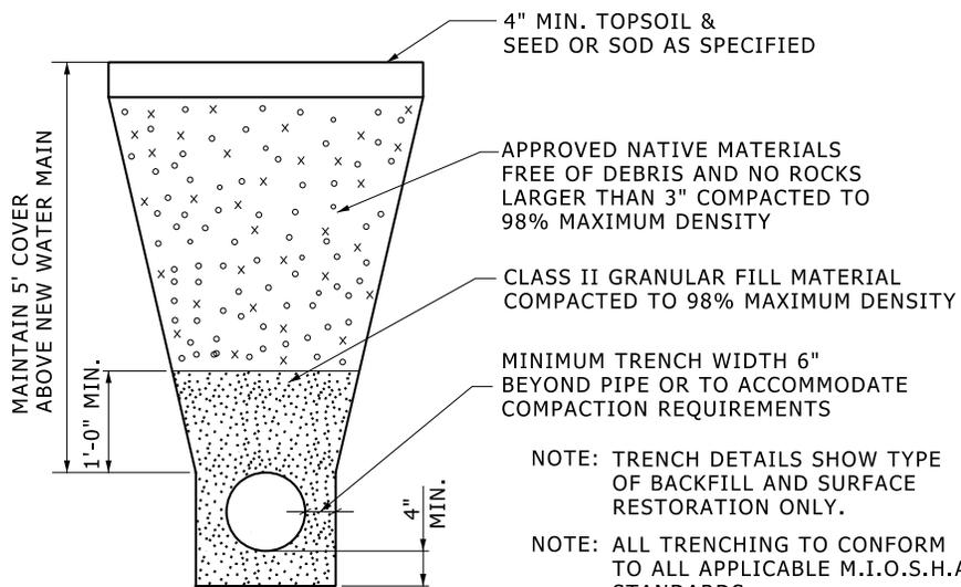
NOTE: TRENCH DETAILS SHOW TYPE OF BACKFILL AND SURFACE RESTORATION ONLY.
