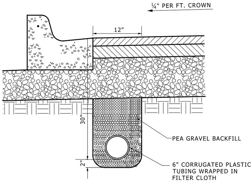
**TYPICAL UNDERDRAIN DETAIL
