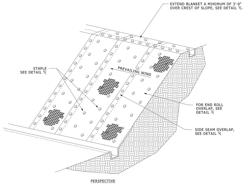
**FIGURE 1: OVERVIEW OF EROSION CONTROL BLANKET**
